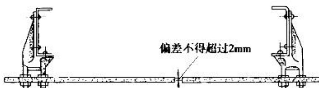
图 4-4-6 左右钢板销孔同轴度
